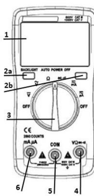
**1. LCD дисплей.****2. Кнопочная панель:****2a. Кнопка «HOLD».**
