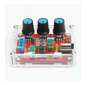
**Настройка частоты** выполняется двумя резисторами — «грубая» — **Coarse** и «точная» — **Fine** настройка, а также джампером выбора диапазона частот. Всего таких диапазонов пять:
