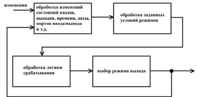
Необходимый алгоритм формируется в текстовом файле формата \*.txt, который в последующем загружается в модуль. В реальном времени выполнения программы можно наблюдать в любой терминальной программе в среде Windows, используя адаптер USB –UART например BM8051.
