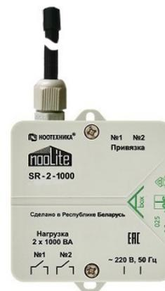
Радиоуправляемый выключатель (силовой блок) **nooLite SR-2-1000** предназначен для включения-выключения нагрузки любого типа, включая лампы накаливания, точечные и линейные галогенные лампы на 220 В, галогенные лампы на 12 В, светодиодные светильники, люминесцентные, энергосберегающие и газоразрядные лампы, контакторы, электродвигатели, нагревательные устройства. Силовой блок имеет исполнение корпуса - IP65, что позволяет использовать его на улице.
