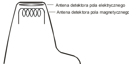
Рис.3 Размещение антенн детекторов в головке приемника
