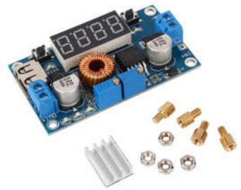
Высокоэффективный импульсный источник питания, обладающий малыми габаритами. Многооборотный переменный резистор CV позволяет максимально точно настроить требуемое выходное напряжение. Переменный резистор CC позволяет установить максимальный ток защиты. Высокий КПД импульсного преобразователя позволяет при минимальных размерах получить высокий выходной ток.
