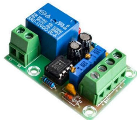
Контроллер заряда 12V аккумуляторной батареи ХН-М601. Модуль включения и отключения зарядного устройства по достижению заданных уровней напряжения для контроля заряда автомобильного 12-вольтового аккумулятора. Модуль позволяет автоматизировать процесс заряда аккумулятора, защищая аккумулятор от перезаряда или переразряда.
