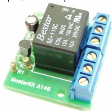
Рис.1 Общий вид исполнительного элемента
