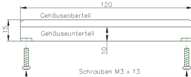
Gehäuseunterteil schwarz mit innenliegenden Befestigungsmöglichkeiten für Platinen.
