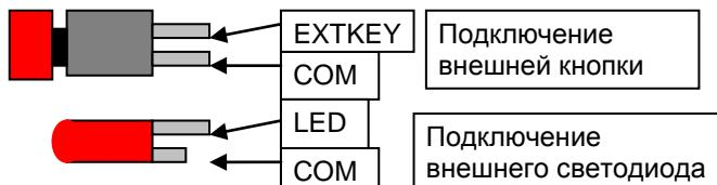
Рис. 12 Подключение элементов управления
