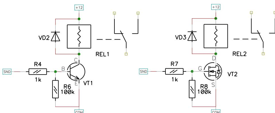
**Рис. 19 Схема безопасного подключения внешней сирены к выходу «SND» и «L3»-«L6» с использованием биполярного ключа (слева) и полевого**
