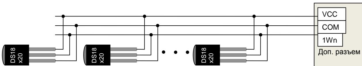
Рис. 16 Способ подключения датчиков DS18S20/DS18B20 по 3-проводнойшине
