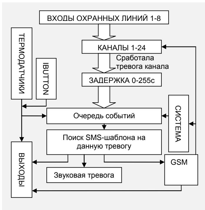
Рис. 1 Алгоритм работы устройства
