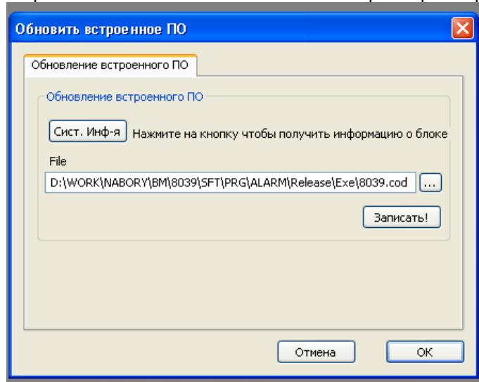
Рис. 44 Окно обновления встроенного ПО (обновление прошивки)
