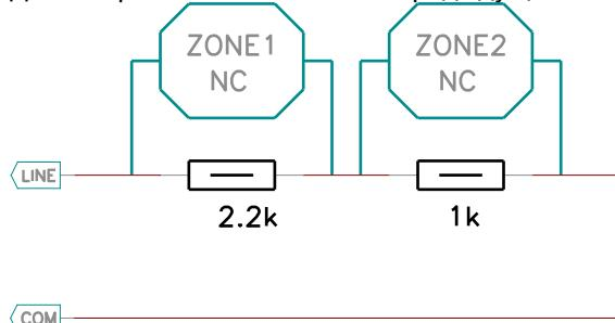
Рис. 25 Пример подключения двух герконовых датчиков (из стандартного комплекта Устройства)
