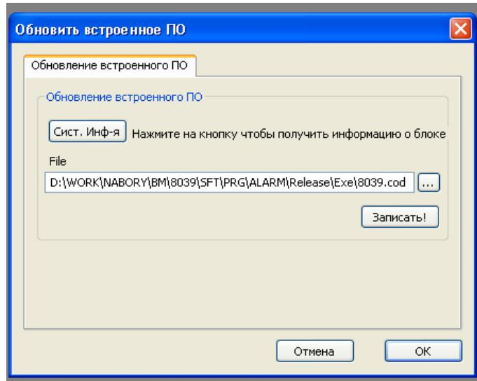
**Рис. 41 Окно обновления встроенного ПО (обновление прошивки)**
