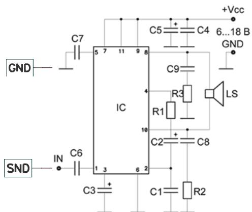
**Рис. 20 Пример подключения сирены через усилитель BM057**
