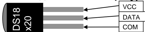
Рис. 14 Распиновка датчика температуры DS18B20/DS18S20/DS1822
