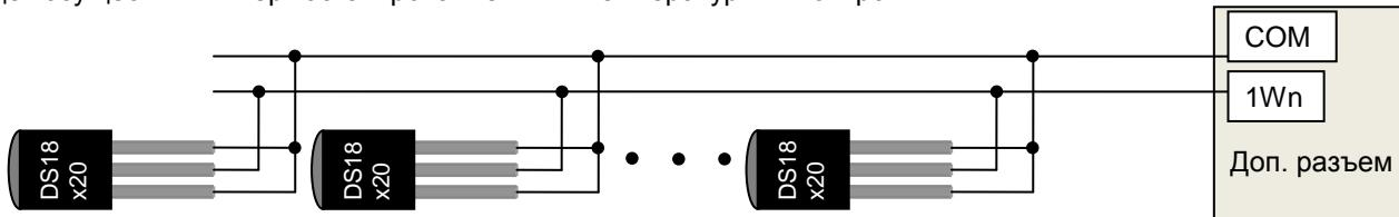
Рис. 15 Способ подключения датчиков DS18S20/DS18B20 по 2-проводнойшине
