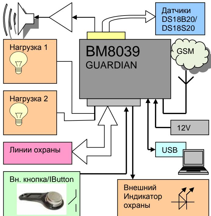
Рис. 4 Схема подключения устройства
