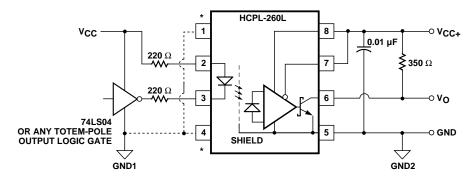
\* HIGHER CMR MAY BE OBTAINABLE BY CONNECTING PINS 1, 4 TO INPUT GROUND (GND1).
