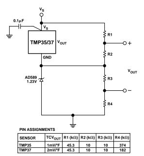
Figure 20a. TMP35/TMP37 Fahrenheit Thermometers
