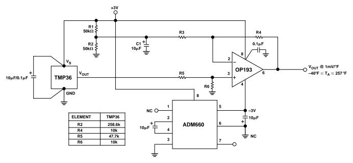
Figure 20c. TMP36 Fahrenheit Thermometer Version 2
