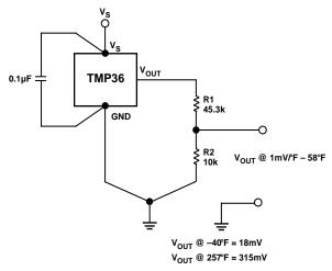
Figure 20b. TMP36 Fahrenheit Thermometer Version 1
