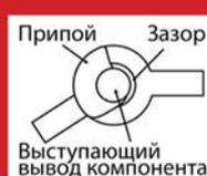
Неполное покрытие припоем контактной площадки и вывода элемента - контакт ненадежный.
