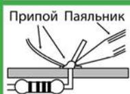
Распределение расплавленного припоя равномерно вокруг вывода компонента.
