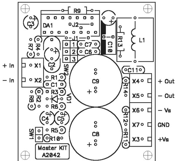
Рис.3 Монтажная схема
