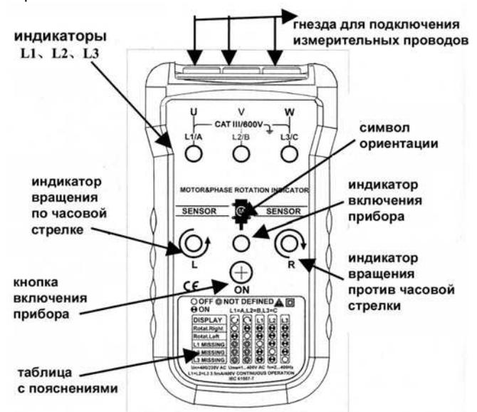
Рисунок 1. Схема прибора
