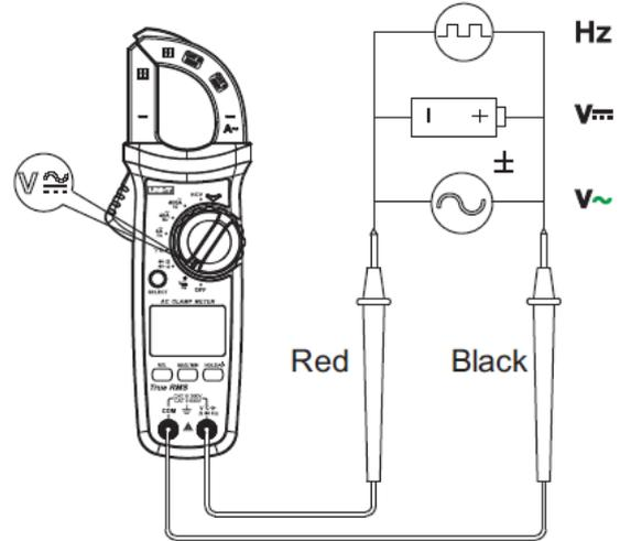
ние V переменного/постоянного и подключите измерительные провода параллельно с нагрузкой или источником питания.
