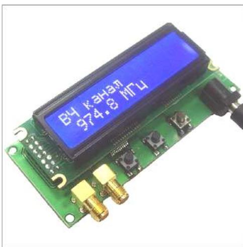
**Рис.1. Общий вид частотомера**
