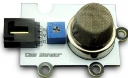
Датчик используется для обнаружения бытового газа, бутана, пропана, метана, паров спирта, водорода, дыма. MP526 имеет маленькое время отклика, что позволяет использовать его в системах безопасности для дома. Во время работы потребляет энергию для подогрева чувствительного элемента.
