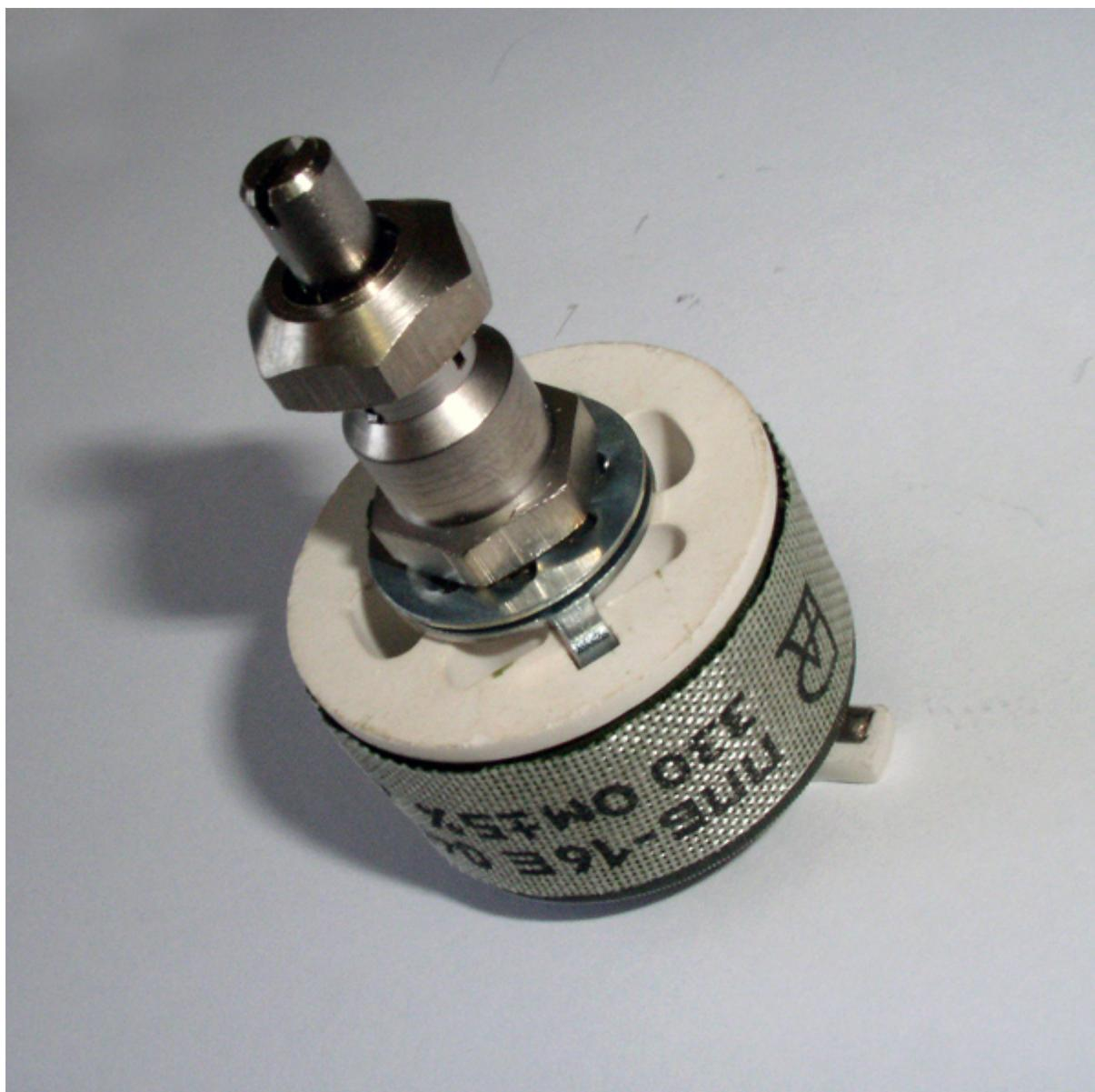
Резисторы переменные проволочные бескаркасные подстроечные (варианты исполнения оси «Б», «В», «Д», «Е») и регулировочные (варианты исполнения оси «А», «Г») однооборотные с круговым перемещением подвижной системы для навесного монтажа, предназначены для работы в цепях постоянного и переменного тока частотой до 1000 Гц. Климатическое исполнение УХЛ.
